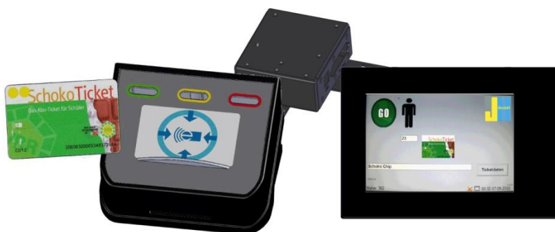
Abbildung von links nach rechts: Kundenschnittstelle (KUSCH), EKS Adapter, Fahrerterminal
